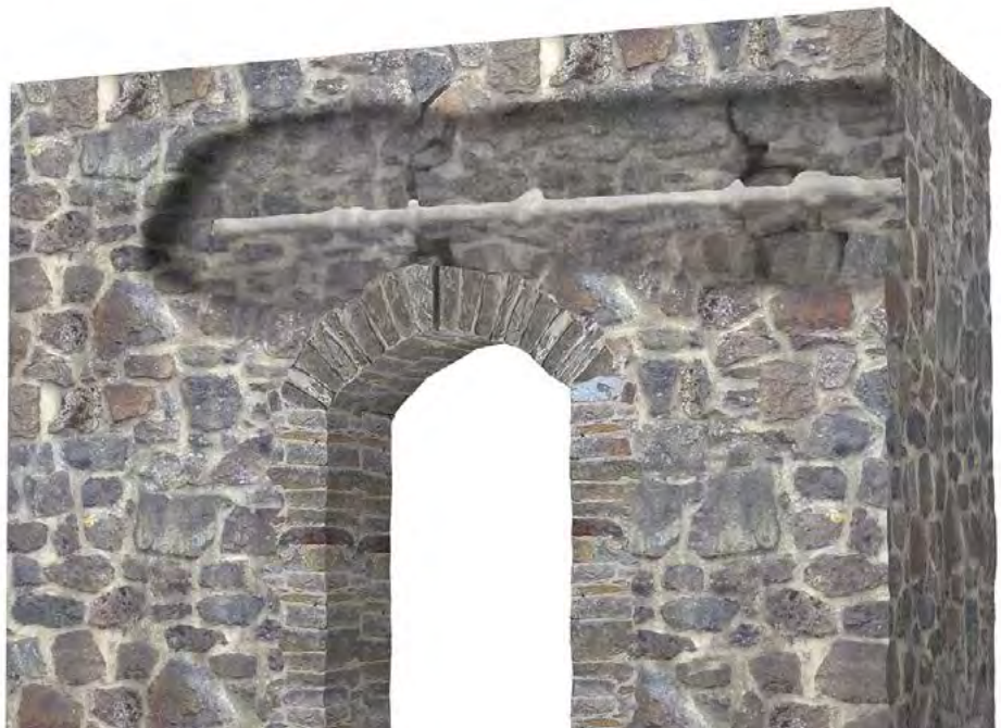
Sicherung gerissener Bauteile | Stabilisation des éléments de construction fissurés
