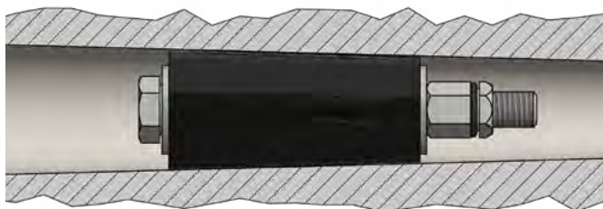
TW-Blindpacker gespannt im konischen Bohrloch TW-Blindpacker tendu dans le trou de forage conique
