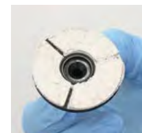
Fertige Klebefläche, Zugang zum Riss bleibt erhalten Surface adhésive préparée, l'accès à la fissure est maintenu
