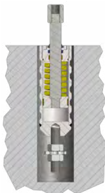
Prinzipskizze: Spannkraftregler Einbau mit Verbundwirkung Schéma: régulateur de charge installé avec effet d'adhérence
