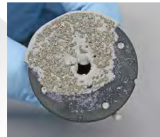
Sehr gute Adhesion auch zwischen Kleber und Packer Très bonne adhésion même entre adhésif et injecteur
