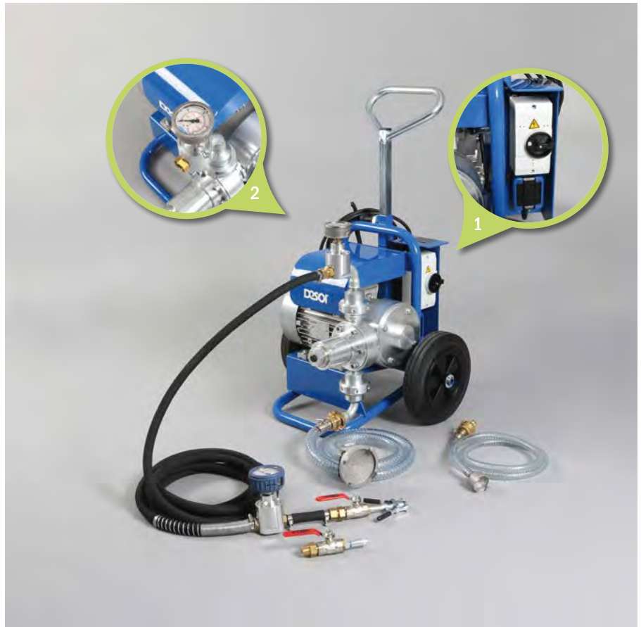
1. Hauptschalter | Main switch
