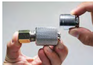
Schiebekupplung auf den Flachkopfnippel aufschieben | Glisser l'accouplement coulissant sur le nippel à tête plate
