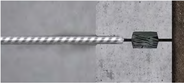
Bis zum Dichtelement bohren Percer jusqu'à l'élément d'étanchéité (Ceci n'est pas nécessaire pour les joints de dilatation).
