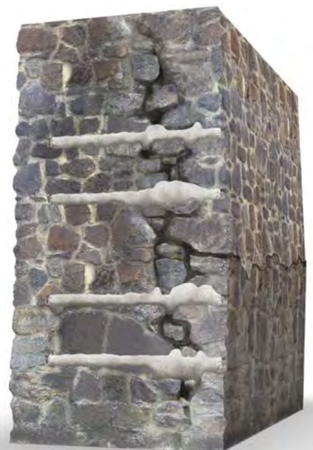
Anbindung abgelöster Mauerwerkschalen Raccordement des murs séparés
