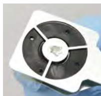
Klebepacker in Klebfix einsetzen Placer l'injecteur à coller dans «Klebfix»
