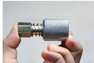
Sicherung gegen die Druckfeder zurückdrücken Repousser le dispositif de sécurité contre le ressort de pression
