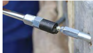
DESOI Snappy auf den Kegelnippel schieben, Sicherheitssteg unten | Pousser le DESOI Snappy sur le nipple à tête ronde (barre de sécurité en bas)
