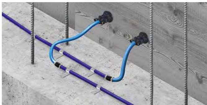
② Montierter Injektionsschlauch mit Nagelpacker ② Tuyau d'injection installé avec injecteurs à clouer
