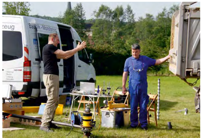
Pfahlprobelastung im Versuchsfeld | Charge d'essai sur pieux dans le champ d'essai
