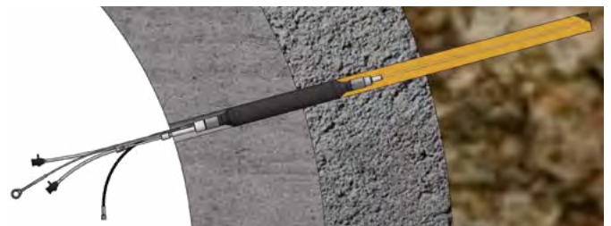
Gespannter Blähpacker mit Entlüftung nach der erfolgreichen Injektion Injecteur gonflable étiré avec ventilation après l'injection réussie
